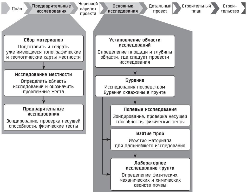
Схема исследований грунта с момента планирования до момента строительства
